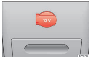
Abb. 194 Hintere Seite der Mittelkonsole: 12-Volt-Steckdose.
