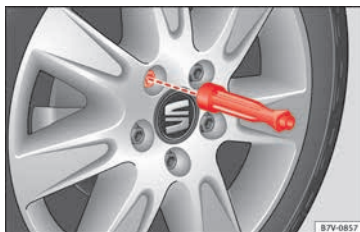
Abb. 72 Radwechsel: Radschrauben mit dem Schraubendrehergriff abschrauben.
