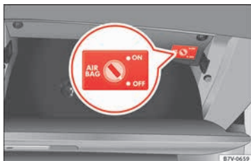
Abb. 28 Im Handschuhfach, auf der Beifahrerseite: Schüsselschalter zum Ab- und Einschalten des Beifahrer-Frontairbags.
