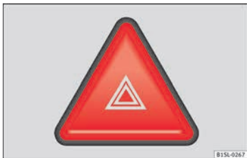
Abb. 141 Ausschnitt von der Instrumententafel: Schalter für die Warnblinkanlage
