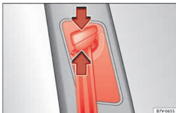
Abb. 91 Bei den Vordersitzen: Gurthöheneinstellung.
