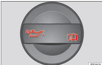
Abb. 243 Im Motorraum: Deckel der Motoröleinfüllöffnung.
