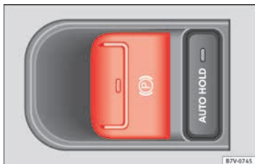
Abb. 202 Detail der Mittelkonsole: Schalter für elektronische Parkbremse.
