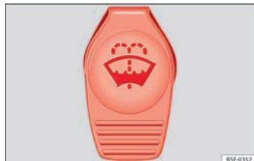
Abb. 248 Im Motorraum: Deckel des Scheibenwaschbehälters.
