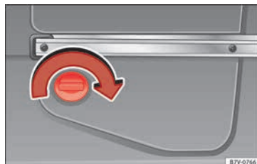
Abb. 237 Hinten links im Gepäckraum: AdBlue-Tank, hinter einer Abdeckung.
