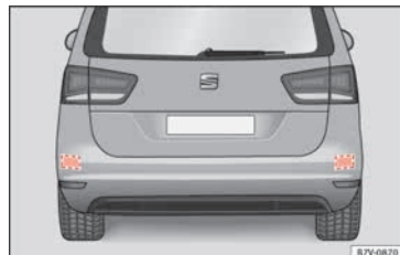
Abb. 222 Bereich hinter dem Fahrzeug: Bereiche der Radarsensoren.
