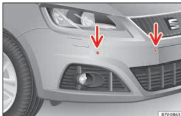
Abb. 210 Sensoren der Parkdistanzkontrolle vorn im Stoßfänger.
