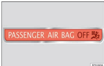
Abb. 92 Kontrollleuchte in der Instrumententafel für abgeschalteten Beifahrer-Frontairbag.
