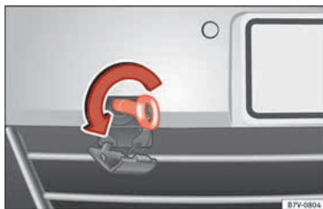
Abb. 104 Im Stoßfänger vorn rechts: Abschleppöse einschrauben.
