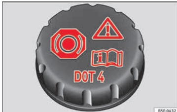
Abb. 58 Motorraum: Deckel des Bremsflüssigkeitsbehälters
