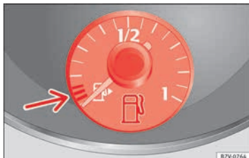
Abb. 235 Im Kombiinstrument: Kraftstoffvorratsanzeige für Benzin und Diesel.
