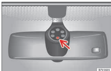
Abb. 146 Sensitive Fläche des Regensensors.
