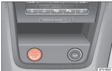
Abb. 200 In der Mittelkonsole: Starterknopf des schlüssellosen Schließ- und Startsystem Keyless Access. Bei Rechtslenker-Fahrzeugen ist die Anordnung symmetrisch.
