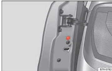
Abb. 4 Am Frontend der Schiebetür: Notverriegelung, durch eine Gummidichtung abgedeckt.
