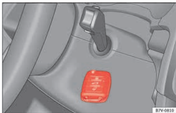
Abb. 201 Notstart bei Fahrzeugen mit Keyless Access.
