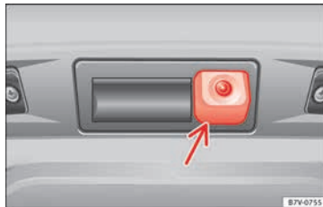
Abb. 215 In der Heckklappe: Einbauort der Kamera des Rückfahrassistenten.
