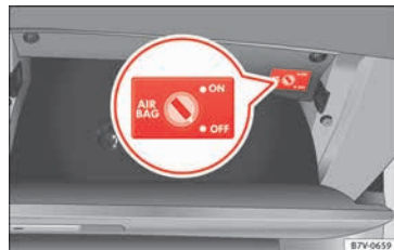
Abb. 93 Im Handschuhfach, auf der Beifahrerseite: Schlüsselschalter zum Ab- und Einschalten des Beifahrer-Frontairbags.
