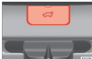
Abb. 8 Vom Gepäckraum aus: Demontage der Abdeckung der Heckklappe.
