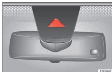
Abb. 220 An der Frontscheibe: Kamerasichtfenster des Spurhalteassistenten.
