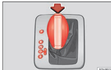
Abb. 49 Automatisches Getriebe: Wählhebelleistellungen.
