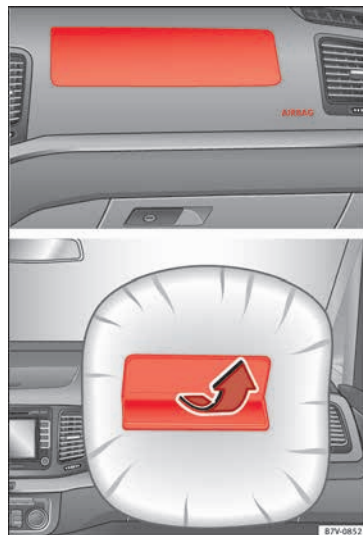
Abb. 27 Einbauort und Wirkungsbereich des Beifahrer-Frontairbags.
