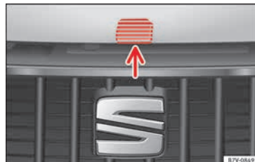
Abb. 240 Entriegelungshebel zum Öffnen der Motorraumklappe im Kühlergrill.
