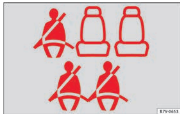
Abb. 84 Beispiel der Gurtstatusanzeige für die hinteren Sitzplätze (hier beim 7-Sitzer) im Kombiinstrument: oben zweite Sitzreihe, unten dritte Sitzreihe.
