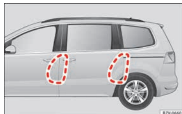
Abb. 32 Wirkungsbereich der Seitenairbags vorn und hinten. Beim 5- und 7-Sitzer.
