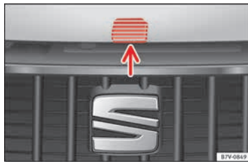
Abb. 11 Hebel unterhalb der Motorraumklappe.
