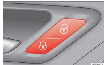
Abb. 131 An der Fahrertür: Zentralverriegelungstaster.
