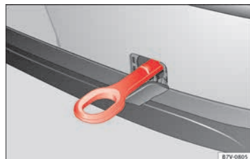
Abb. 105 Im Stoßfänger hinten rechts: eingeschraubte Abschleppöse.
