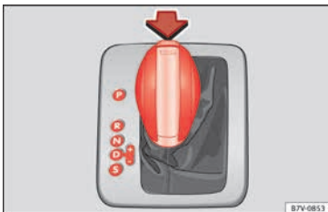
Abb. 203 Wählhebel des automatischen Getriebes mit Sperrtaste (Pfeil).
