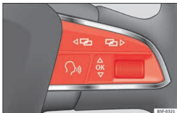
Abb. 46 Multifunktionslenkrad: Tasten zum Bedienen der Menüs im Kombiinstrument.
