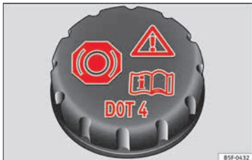
Abb. 247 Im Motorraum: Deckel des Bremsflüssigkeitsbehälters
