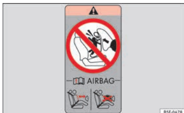
Abb. 36 Im hinteren Rahmen der Beifahrertür: Aufkleber mit Angaben zum Airbag.
