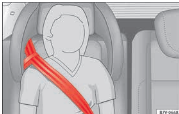
Abb. 97 Integrierter Kindersitz: Gurtbandverlauf mit Gurtführungsschleufe.
