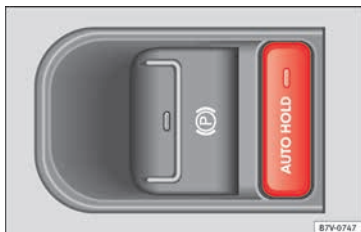
Abb. 207 Ausschnitt aus der Mittelkonsole: Taster für Auto Hold
