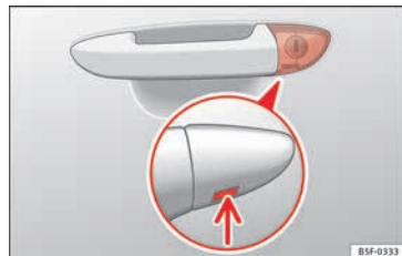
Abb. 3 Türgriff an der Fahrtür: verdeckter Schließzylinder.
