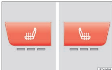
Abb. 156 Ausschnitt aus der Mittelkonsole: Regler für die Sitzheizung der Vordersitze in Fahrzeugen mit Climatronic.
