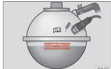
Abb. 245 Im Motorraum: Markierung an dem Motor Kühlmittelausgleichsbehälter.
