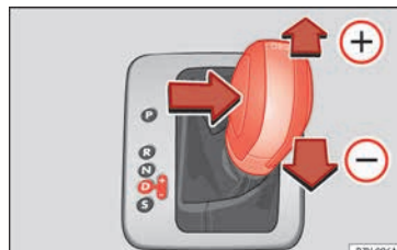
Abb. 204 Wählhebel in Tiptronic-Stellung (Linkslenker). Rechtslenker spiegelbildlich.
