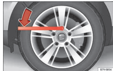
Abb. 68 Radwechsel: Radschrauben lockern.
