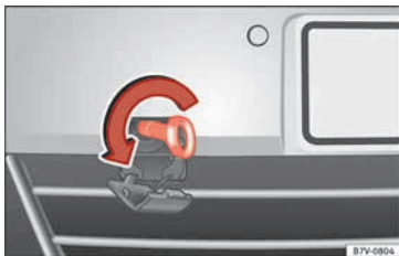
Abb. 73 Im Stoßfänger vorn rechts: Abschleppöse einschrauben.
