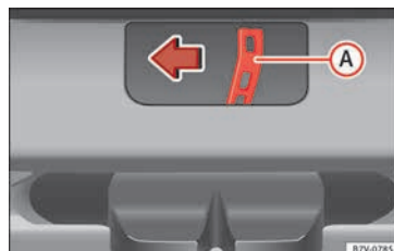
Abb. 9 Vom Gepäckraum aus: Heckklappe notentriegeln.
