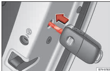
Abb. 5 Notverriegelung des Fahrzeugs mit dem Fahrzeugschlüssel.
