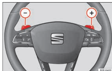
Abb. 205 Lenkrad mit zwei Schaltwippen für die Tiptronic.
