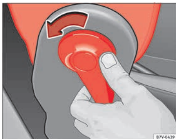
Abb. 161 Klappbare Beifahrersitzlehne entriegeln.
