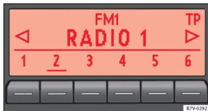
Abb. 12 TP-Funktion eingeschaltet und funktionsbereit. ▶
