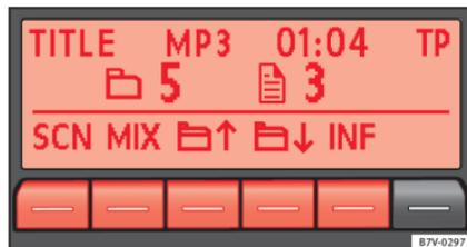
Abb. 22 Anzeige des Speicherorts beim Titelwechsel im MP3-Betrieb.
