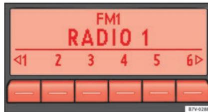
**Abb. 5** Senderwechsel über die Pfeiltasten nur zu gespeicherten Sendern möglich.
