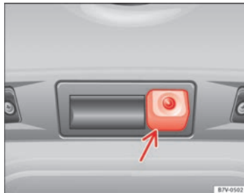
Abb. 147 In der Heckklappe: Einbauort der Kamera des Rückfahrassistenten.
