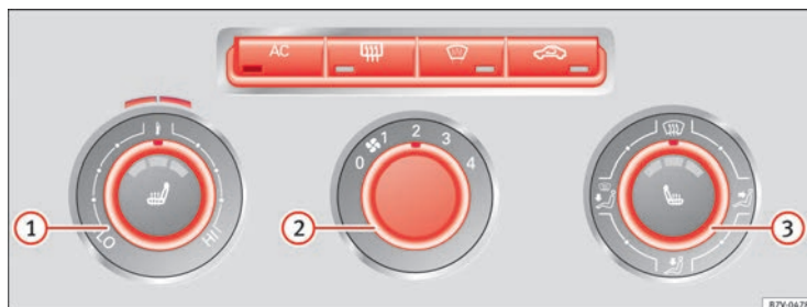
Abb. 122 Ansicht der Mittelkonsole: Bedienelemente der elektrischen manuellen Klimaanlage.
