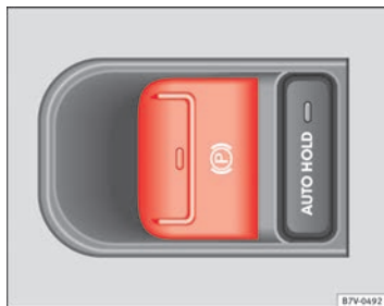
Abb. 136 Ansicht der Mittelkonsole: Taste für die elektronische Parkbremse.
