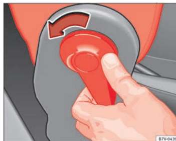
Abb. 83 Klappbare Beifahrersitzlehne einlegen.
