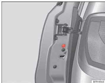
Abb. 191 In der Stirnseite der Beifahrertür: Notverriegelung, durch eine Gummidichtung abgedeckt.
