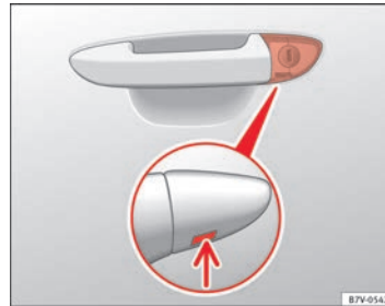
Abb. 190 Türgriff an der Fahrtür; verdeckter Schließzylinder.
