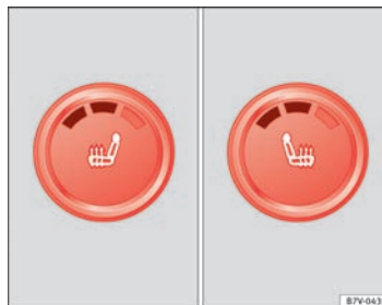
Abb. 78 Ansicht der Mittelkonsole: Regler für die Sitzheizung der Vordersitze, hier bei eingestellter zweiter Heizstufe.
