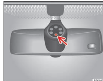
Abb. 69 Sensitive Fläche des Regensensors.
