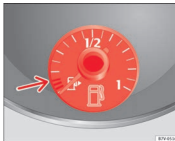
Abb. 164 Im Kombiinstrument: Kraftstoffvorratsanzeige für Benzin- und Dieseldieselkraftstoff. ▶
