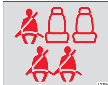
Abb. 4 Beispiel der Gurtstatusanzeige für die hinteren Sitzplätze (hier beim 7-Sitzer) im Kombiinstrument: oben zweiten Sitzreihe, unten dritten Sitzreihe. ▶
