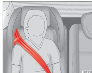
Abb. 32 Integrierter Kindersitz: Gurtbandverlauf mit Gurtführungsschlaufe.
