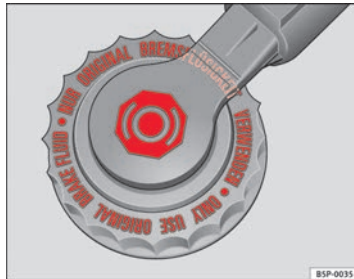
Abb. 138 Im Motorraum: Deckel des Bremssflüssigkeitsbehälters.
