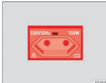
Abb. 121 Mittelkonsole hinten: 230-Volt-Eurosteckdose.
