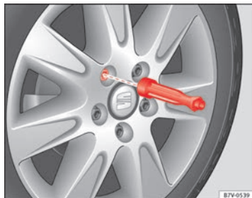
Abb. 187 Radwechsel: Radschrauben mit dem Schraubendrehergriff ab- schrauben.
