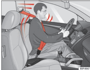
Abb. 9 Angegurterter Fahrer, der bei einem plötzlichen Bremsmanöver vom richtig angelegten Sicherheitsgurt aufgefangen wird.
