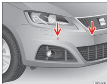
Abb. 142 Sensoren der Parkdistanzkontrolle vorn im Stoßfänger.
