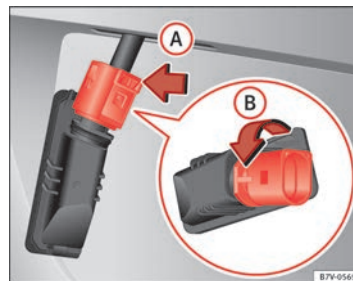
Abb. 216 Kennzeichenleuchte: Lampenhalter ausbauen.
