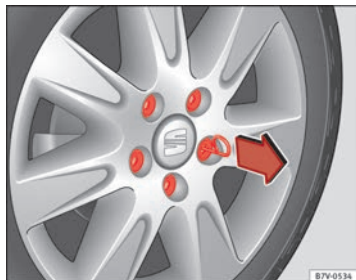
Abb. 182 Abdeckkappen von den Radschrauben abziehen.
