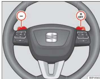
Abb. 135 Lenkrad mit zwei Schaltwippen für die Tiptronic.
