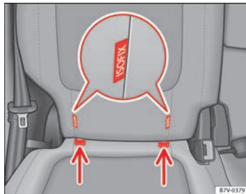
Abb. 27 Variante 2: Kennzeichnung der unteren Kindersitzverankerungspunkte am Fahrzeugsitz.
