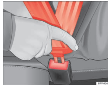
Abb. 10 Schloßzunge des Sicherheitsgurts in das Gurtschloß einstecken.
