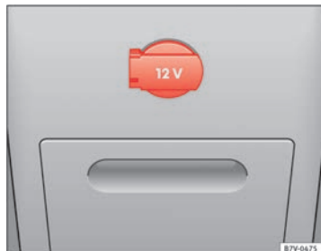
Abb. 120 In der Mittelkonsole hinten: 12-Volt-Steckdose.
