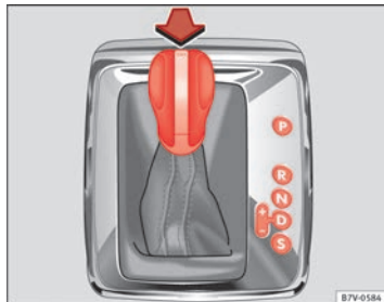
Abb. 133 Rechtslenker: Wählhebel des Automatikgetriebes mit Sperrtaste (Pfeil).
