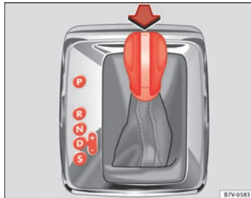
Abb. 132 Linkslenker: Wählhebel des Automatikgetriebes mit Sperrtaste (Pfeil).
