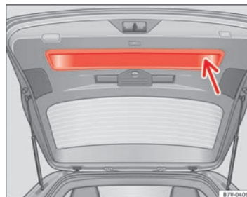
Abb. 54 Heckklappe geöffnet: Griffmulde zum Zuziehen.
