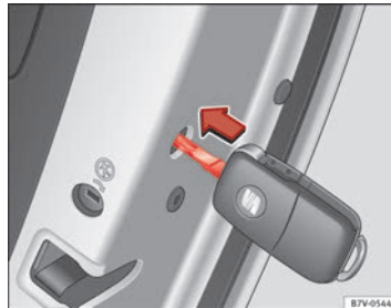
Abb. 192 Notverriegelung des Fahrzeugs mit dem Fahrzeugschlüssel.
