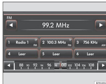
Abb. 8 Hauptmenü **RADIO** mit Frequenzband des gewählten Frequenzbereichs. ▶
