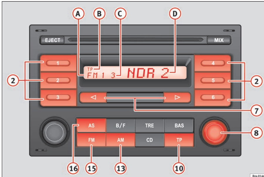
Abb. 4 Übersicht der Bedienelemente und der Display-Anzeige im Radio-Betrieb
