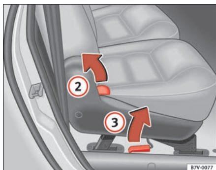
Abb. 90 Seitenbereich des Sitzes: Rückenlehne und Sitz vorklappen
