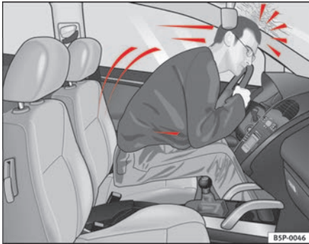
Abb. 7 Der nicht angegurte Fahrer fliegt nach vorne
