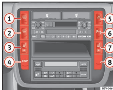
Abb. 77 Mittelkonsole: Taster für Heckscheibenbeheizung
