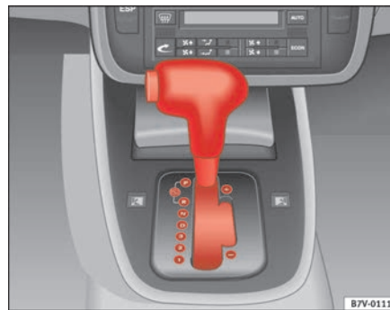
Abb. 128 Mittelkonsole: Wählhebel mit Sperrtaste des Automatikgetriebes
