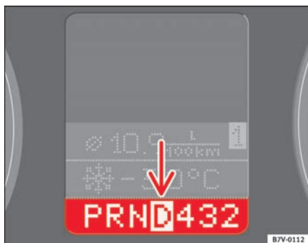
Abb. 131 Kombiinstrument: Anzeige für Wählhebelstellung
