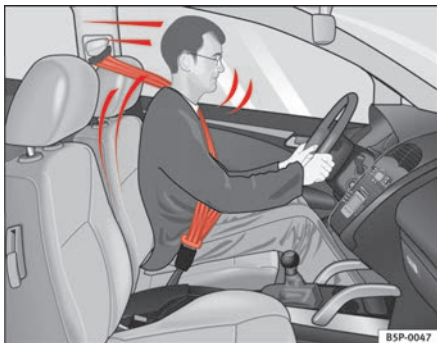
Abb. 9 Fahrer mit einem korrekt angelegten Sicherheitsgurt: er wird bei einer Vollbremsung durch den Gurt gesichert
