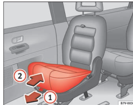
Abb. 41 Bedienung des integrierten Kindersitzes
