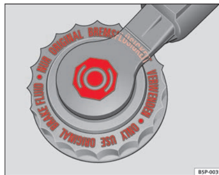
Abb. 148 Im Motorraum: Abdeckung des Bremsflüssigkeitsbehälters
