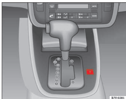
Abb. 113 Lage des AUX-IN-Anschlusses
