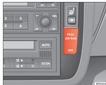
Abb. 29 Kontrollleuchte in der Instrumententafel für Airbagschaltung
