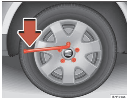
Abb. 158 Radwechsel: Radschrauben lockern
