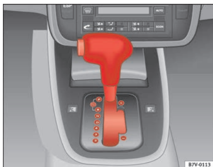
Abb. 130 Mittelkonsole: Wählhebel und Sperrtaste
