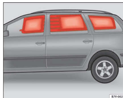
Abb. 27 Prinzipdarstellung: Aufgeblasener Kopfairbag
