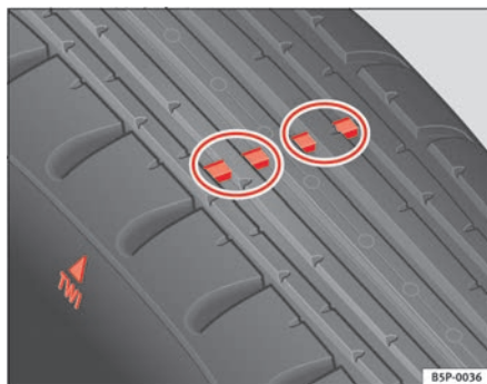
Abb. 149 Prinzipdarstellung Reifenprofil: Verschleißanzeiger
