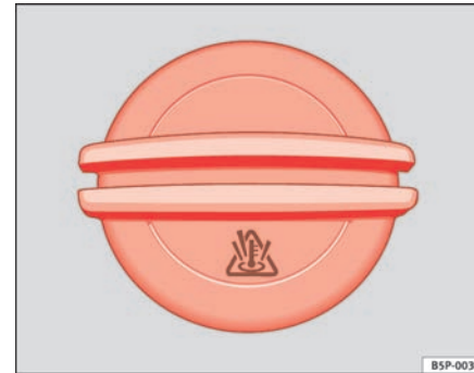
Abb. 143 Im Motorraum: Deckel des Kühlmittel- Ausgleichsbehälters
