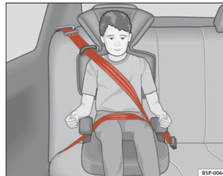
Abb. 32 In Fahrtrichtung eingebauter Kindersitz auf dem Rücksitz
