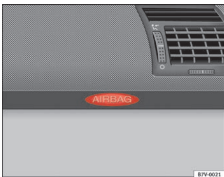
Abb. 23 Einbauort Beifahrer-Frontairbag: in der Instrumententafel
