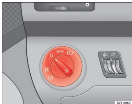
Abb. 70 Ausschnitt aus der Instrumententafel: Schalter für die Leuchten, Nebelscheinwerfer und Nebelschlussleuchte
