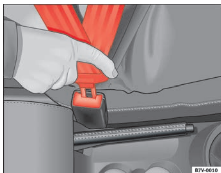
Abb. 10 Gurtschloss und Schloßzunge des Sicherheitsgurtes
