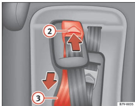
Abb. 39 Integrierter Kindersitz: Einstellung des Hosenträgergurtes
