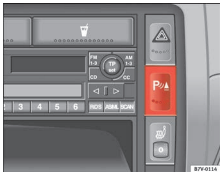
Abb. 132 Ausschnitt aus der Instrumententafel: Schalter für Parkdistanzkontrolle
