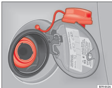
Abb. 137 Tankeinfüllstutzen und Tankklappe
