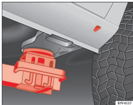
Abb. 176 Anheben mit der Hebebühne: Aufnahmepunkt hinten links
