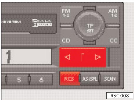
Il est possible de réaliser la sélection des différents points du menu de programmation à l'aide de la touche TP/Set ou à l'aide d'une des touches basculantes. La permutation sur les points du menu est indiquée avec un signal acoustique.
