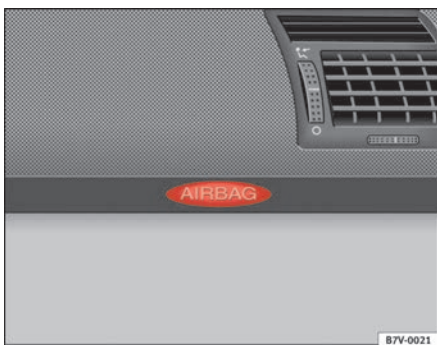
Abb. 23 Einbauort Beifahrer-Frontairbag: in der Instrumententafel
