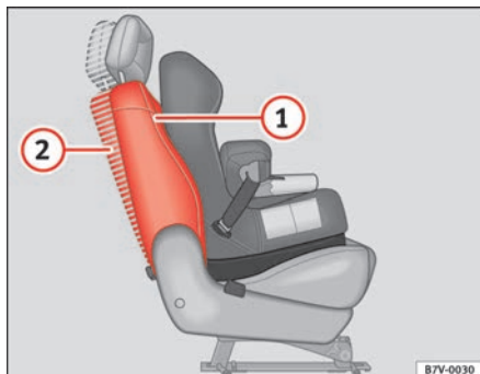
Abb. 34 Rückenlehnenstellung bei Verwendung von ISOFIX-Kindersitzen
