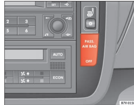
Abb. 29 Kontrollleuchte in der Instrumententafel für Airbagabschaltung
