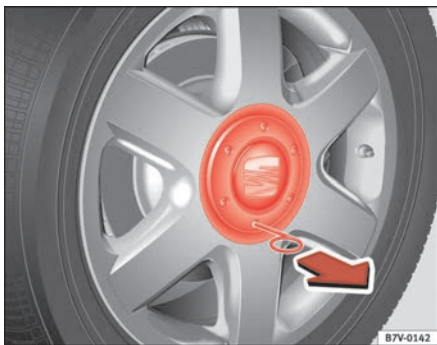
Abb. 155 Radwechsel: Radmittenblende abnehmen
