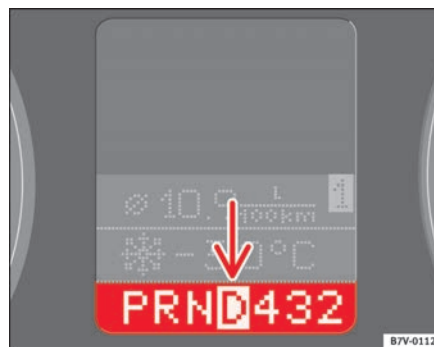
Abb. 128 Ausschnitt aus dem Kombiinstrument: Display mit eingeleger Wählhebelstellung
