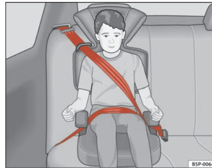
Abb. 32 In Fahrtrichtung eingebauter Kindersitz auf dem Rücksitz.
