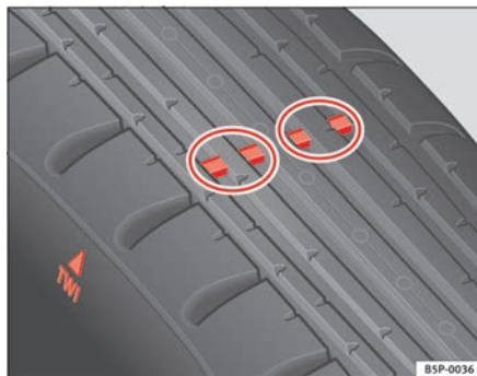
Abb. 148 Prinzipdarstellung Reifenprofil: Verschleißanzeiger
