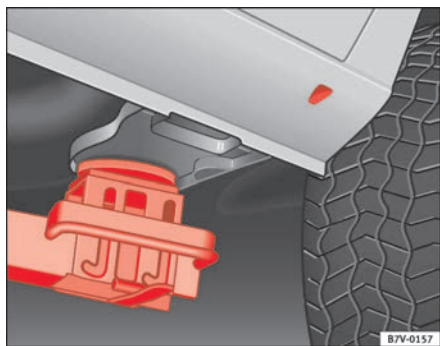
Abb. 175 Anheben mit der Hebebühne: Aufnahmepunkt hinten links
