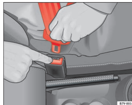
Abb. 16 Lösen der Schloßzunge vom Gurtschloss
