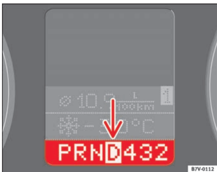
Abb. 130 Ausschnitt aus dem Kombiinstrument: Display mit eingelegter Wählhebelstellung
