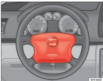
Abb. 22 Einbauort Fahrerairbag: im Lenkrad
