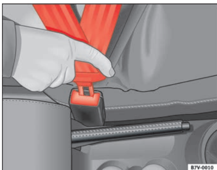
Abb. 10 Gurtschloss und Schloßzunge des Sicherheitsgurtes
