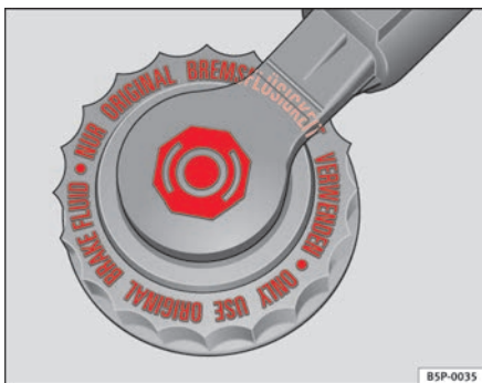
Abb. 147 Im Motorraum: Abdeckung des Brems- flüssigkeitsbehälters
