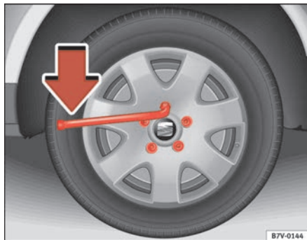
Abb. 157 Radwechsel: Radschrauben lockern
