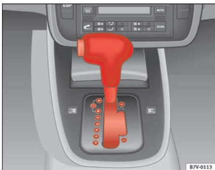
Abb. 129 Ausschnitt aus der Mittelkonsole: Wählhebel mit Sperrtaste
