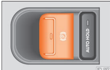
Abb. 266 In der Mittelkonsole: Taste für elektronische Parkbremse.
