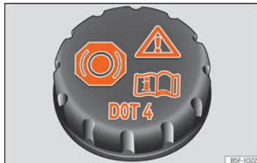
Abb. 292 Motorraum: Deckel des Bremsflüssigkeitsbehälters.
