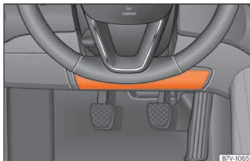
Abb. 20 Auf der Fahrerseite: Einbauort des Knieairbags.
