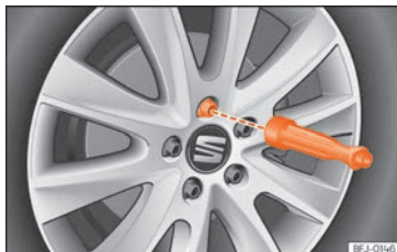
Abb. 49 Radwechsel: Radschrauben mit dem Schraubendrehergriff herausdrehen.
