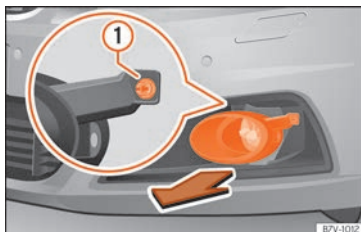
Abb. 66 Im Stoßfänger vorn rechts: Ausbau der Scheinwerfer.
