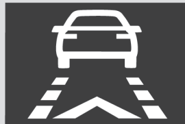
Abb. 252 Am Bildschirm des Kombi-Instruments: Anzeigen der Vorwarnung.
