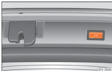
Abb. 104 Taste in der geöffneten Heckklappe.
