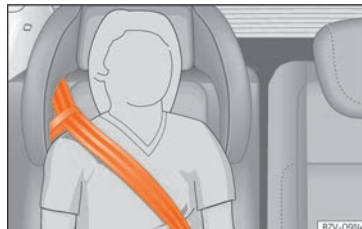
Abb. 35 Integrierter Kindersitz: Gurtbandverlauf mit Gurtführungsschleufe.
