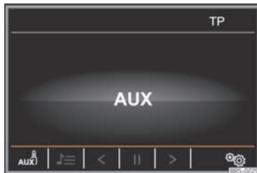
Abb. 210 Medien-Betrieb: Externe Audioquelle über Buchse AUX-IN angeschlossen.
