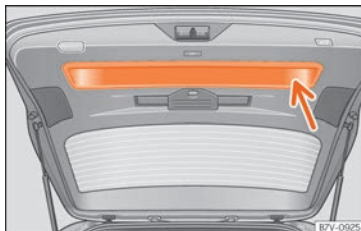
Abb. 103 Offene Heckklappe: Griffmulde zum Zuziehen.
