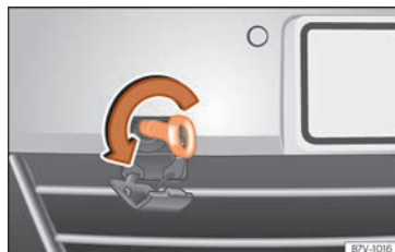
Abb. 56 Im Stoßfänger vorn rechts: Abschleppöse einschrauben.
