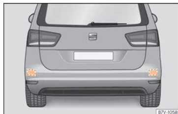
Abb. 247 Heckansicht des Fahrzeugs: Bereiche der Radarsensoren.
