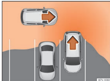
Abb. 265 Schematische Abbildung des Ausparkassistenten: Überwachter Bereich des ausparkenden Fahrzeugs.
