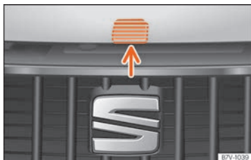
Abb. 284 Hebel unter der Motorraumklappe.
