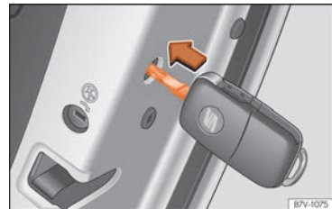
Abb. 97 Notverriegelung des Fahrzeugs mit dem Fahrzeugschlüssel.
