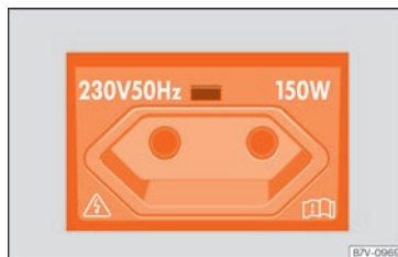
Abb. 172 Ausschnitt aus der hinteren Mittelkonsole: 230-Volt-Eurosteckdose.
