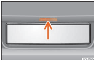
Abb. 105 Heckklappe von außen öffnen.
