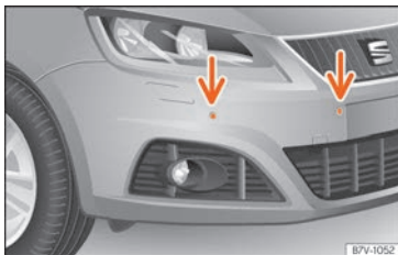
Abb. 272 Sensoren der Parkdistanzkontrolle vorn im Stoßfänger.
