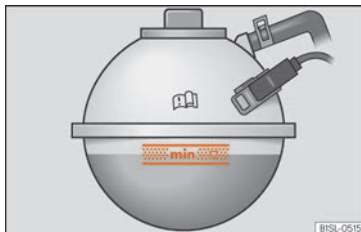
Abb. 290 Im Motorraum: Markierung an dem Motorkühlmittelausgleichsbehälter.
