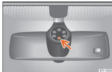
Abb. 122 Sensitive Fläche des Regensensors.
