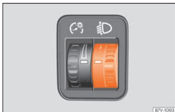
Abb. 118 Neben dem Lenkrad: Regler für die Leuchtweitenregulierung.
