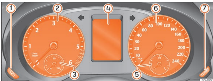
Abb. 75 Display des Kombi-Instruments in der Instrumententafel.
