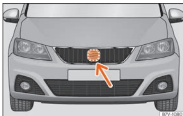
Abb. 244 Am vorderen Stoßfänger: Radarsensor.
