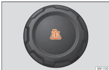
Abb. 291 Motorraum: Deckel des Motorkühlmittelausgleichsbehälters.
