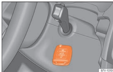
Abb. 235 Notstart bei Fahrzeugen mit Keyless Access.
