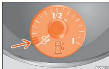
Abb. 78 Im Kombiinstrument: Kraftstoffvorratsanzeige »
