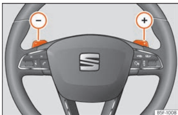
Abb. 240 Lenkrad mit zwei Schaltwippen für die Tiptronic.
