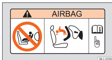
Abb. 27 Airbagaufkleber: an der Sonnenblende auf der Beifahrerseite
