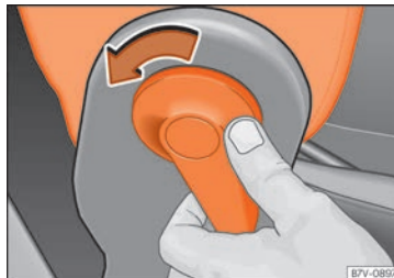
Abb. 139 Klappbare Beifahrersitzlehne entriegeln.
