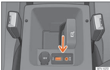
Abb. 231 Mittelarmlehne vorne: USB/AUX-IN Anschluss.
