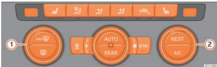
Abb. 173 In der Mittelkonsole: Bedienungselemente der Climatronic.
