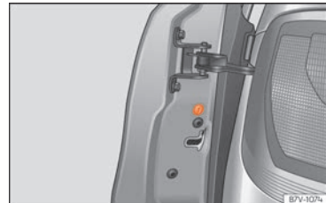
Abb. 96 Im vorderen Teil der Schiebetür: Notverriegelung, durch eine Gummidichtung verdeckt.
