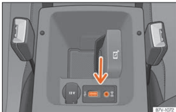
Abb. 185 Mittelarmlehne vorne: USB/AUX-IN Anschluss.
