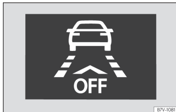
Abb. 253 Am Bildschirm des Kombi-Instruments: Anzeige, dass Front Assist ausgeschaltet ist.
