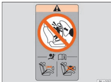
Abb. 28 Airbagaufkleber: Im hinteren Rahmen der Beifahrertür
