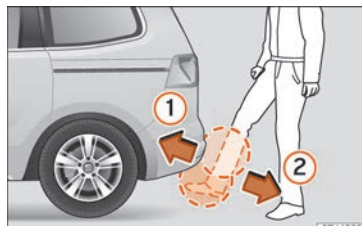
Abb. 106 Heckklappe mit sensorgesteuerter Öffnung (Easy Open).
