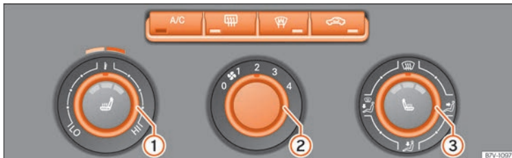
Abb. 174 In der Mittelkonsole: Bedienungselemente für die Klimaanlage.
