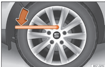
Abb. 45 Radwechsel: Radschrauben lockern.
