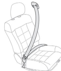
Die vorderen Sicherheitsgurte sind mit pyrotechnischen Gurtstraffern und Gurtkraftbegrenzern ausgestattet. Dadurch erhöht sich bei einem Frontal- und Seitenaufprall die Sicherheit auf den vorderen Plätzen. Je nach Heftigkeit des Aufpralls werden die Gurte durch den pyrotechnischen Gurtstraffer schlagartig gespannt, sodass sie fest am Körper der Insassen anliegen.
