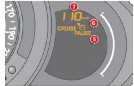
Die programmierten Daten werden im Kombiinstrument angezeigt
