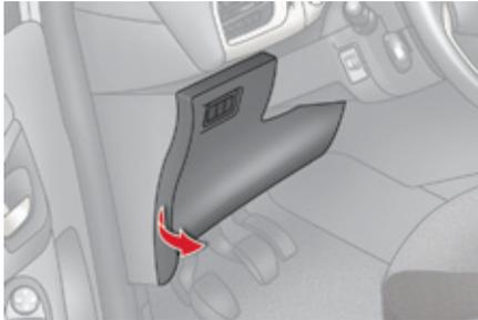
Die Zange zum Abziehen der Sicherungen und die für Ersatzsicherungen vorgesehenen Einbaustellen befinden sich an der Deckelrückseite des Sicherungskastens am Armaturenbrett.
