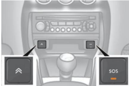
**!** Wenn das Airbag-Steuergerät einen Aufprall registriert, wird auch unabhängig von einem etwaigen Auslösen des Airbags automatisch ein Notruf abgesetzt.
