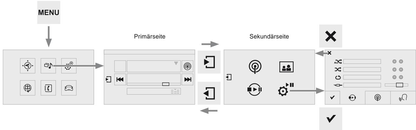
Schnellzugriff: mit den Tasten in der oberen Leiste des Touchscreens kann man direkt zur Auswahl der Audioquelle, der Senderliste (oder je nach Audioquelle der Titelliste) gelangen.
