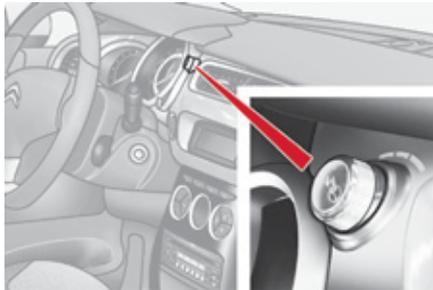
Dieser Regler befindet sich am Armaturenbrett. Mit diesem Regler kann die Intensität der Duftstoffverteilung eingestellt werden.
