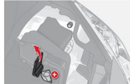
Die Batterie befindet sich im Motorraum.
