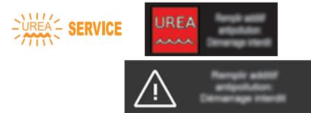
Mit dem Einschalten der Zündung leuchtet die Kontrollleuchte für Service und die Kontrollleuchte UREA blinkt, es ertönt ein Warnsignal und die Meldung "Abgas-Additiv einfüllen: Anlasser gesperrt" wird eingeblendet.
