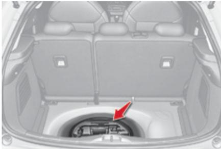
Das Werkzeug befindet sich im Kofferraum unter dem Bodenbelag.
