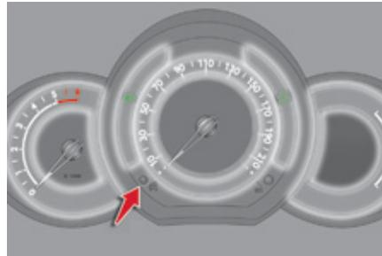
Bei Nachtfahrt ermöglicht diese Funktion bestimmte Anzeigen des Kombiinstruments zu deaktivieren, um die visuelle Ermüdung des Fahrers zu verringern. Die wichtigen Fahrinformationen, wie die Geschwindigkeit des Fahrzeugs, die Kontrollleuchten, der Geschwindigkeitsbegrenzer oder -regler bleiben im Kombiinstrument angezeigt.
