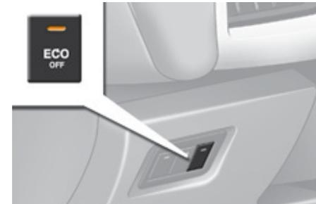
Drücken Sie jederzeit die Taste "ECO OFF", um das System zu deaktivieren. Die Deaktivierung wird durch Aufleuchten der Kontrollleuchte der Betätigung in Verbindung mit einer Meldung auf dem Bildschirm angezeigt.
