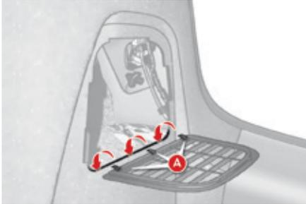
Positionieren Sie die 3 Haken **A** der Klappe im unteren Bereich.
