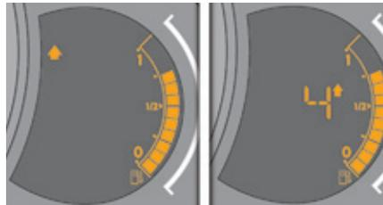
Der Hinweis erscheint in Form eines Pfeils in Verbindung mit dem empfohlenen Gang im Kombiinstrument.
