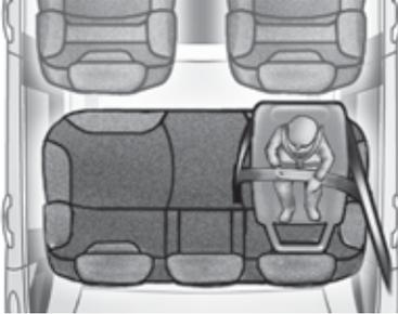
Wenn ein Kindersitz "entgegen der Fahrtrichtung" auf einem **Rücksitz** eingebaut wird, schieben Sie den Vordersitz des Fahrzeugs nach vorne und richten Sie die Rückenlehne auf, sodass der Kindersitz "entgegen der Fahrtrichtung" nicht den Vordersitz des Fahrzeugs berührt.
