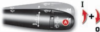
Sie wird vom Fahrer manuell ausgeschaltet, indem er die Betätigung **A** nach oben bewegt und dann auf "0" zurückstellt.
