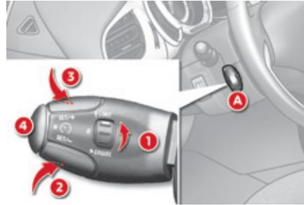
Die Bedienung des Geschwindigkeitsbegrenzers erfolgt über den Hebel **A**.
