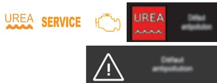
Die Kontrollleuchten für UREA, SERVICE und Motorselbstdiagnose leuchten, in Verbindung mit einem Warnsignal und der Meldung "Fehler Abgasreinigung".
