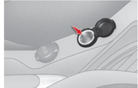
☞ Um ein Zubehörteil mit 12V-Betriebsspannung (maximale Leistung: 120 W) anzuschließen, entfernen Sie die Verschlusskappe und verwenden Sie einen geeigneten Adapter.
