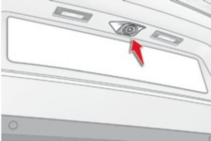
Bei Einlegen des Rückwärtsgangs wird eine Rückfahrkamera automatisch aktiviert. Die Kamera liefert ein Farbbild auf dem Navigationsbildschirm.
