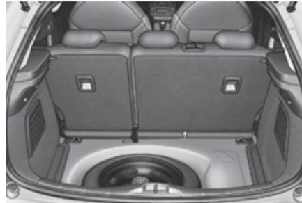
Das Ersatzrad befindet sich im Kofferraum unter dem Bodenbelag.
