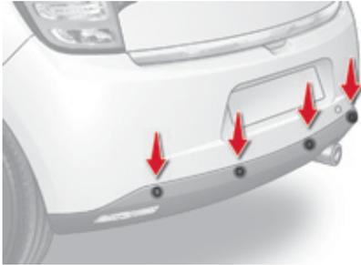
Es erkennt jedes Hindernis (Person, Fahrzeug, Baum, Schranke, etc.) hinter dem Fahrzeug, mit der Ausnahme von Hindernissen, die sich direkt unter dem Stoßfänger befinden.
