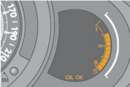
Bei Modellen mit einer elektrischen Ölstandsanzeige wird beim Einschalten der Zündung nach der Wartungsinformation einige Sekunden lang der Motorölstand am Kombiinstrument angezeigt.
