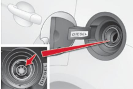
Mechanische Vorrichtung, die das Tanken mit Benzin bei einem Fahrzeug mit Dieselmotorisierung verhindert. Somit werden Beschädigungen am Motor, die durch solch ein Falschtanken verursacht werden, vermieden.
