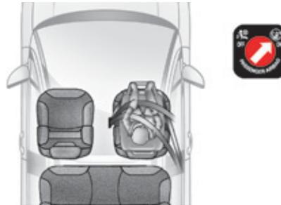
Wenn ein Kindersitz "in Fahrtrichtung" auf dem **Beifahrersitz vorne** installiert wird, schieben Sie den Fahrzeugsitz in die mittlere Längsposition, stellen Sie die Lehne senkrecht und lassen Sie den Beifahrer-Front-Airbag aktiviert.
