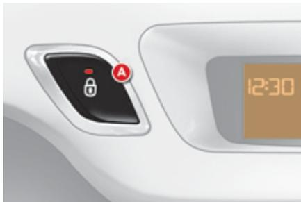
System zur vollständigen manuellen Verriegelung bzw. Entriegelung der Türen von innen.
