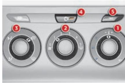
Das Heizungs- und Belüftungssystem oder die Klimaanlage funktionieren nur bei laufendem Motor. Im Modus STOP der STOP & START-Funktion bleibt die Klimaanlage in Standby.
