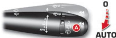
Die Wischautomatik wird vom Fahrer manuell eingeschaltet, indem er die Betätigung **A** durch einmaliges Drücken auf "AUTO" stellt.
