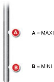
Wenn Sie feststellen, dass sich der Füllstand oberhalb der Markierung **A** oder unterhalb der Markierung **B** befindet, **starten Sie den Motor nicht**.
