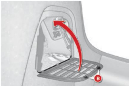
Klappen Sie die Klappe nach oben und positionieren Sie die Haken **B** unter der Kofferraumverkleidung.
