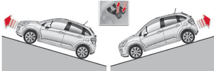
**An Steigungen wird das stehende Fahrzeug beim Lösen des Bremspedals kurzzeitig angehalten:**
