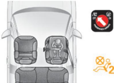
Wenn ein Kindersitz "entgegen der Fahrtrichtung" auf dem **Beifahrersitz vorne** eingebaut wird, muss der Sitz des Fahrzeugs in die mittlere Längsposition und mit gerader Rückenlehne eingestellt werden. Der Beifahrer-Front-Airbag muss unbedingt deaktiviert werden. Andernfalls **könnte das Kind beim Entfalten des Airbags schwere oder sogar tödliche Verletzungen erleiden.**
