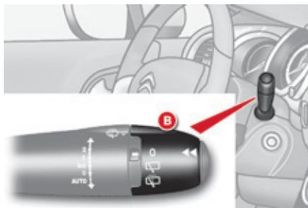
**!** Bei starkem Schneefall oder Frost und bei Benutzung eines Fahrradträgers an der Heckklappe schalten Sie bitte die Automatikfunktion des Heckscheibenwischers über das Konfigurations-Menü auf dem Multifunktionsbildschirm aus.
