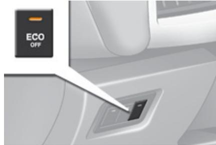
Bei einer Funktionsstörung blinkt die Taste "**ECO OFF**" und leuchtet anschließend ununterbrochen auf. Lassen Sie das System von einem Vertreter des CITROËN-Händlernetzes oder einer qualifizierten Fachwerkstatt überprüfen.
