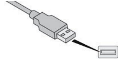
Schließen Sie das Gerät der Firma Apple® mit einem geeigneten Kabel (nicht im Lieferumfang enthalten) an den USB-Anschluss im Handschuhfach an. Die Wiedergabe erfolgt automatisch. Die Steuerung erfolgt über die Bedientasten des Audiosystems.
