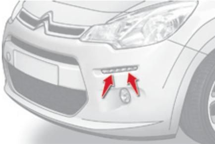
Beim Starten des Fahrzeugs bei Tag, schaltet sich das Tagfahrlicht automatisch ein, wenn der Beleuchtungshebel auf Position "0" oder "AUTO" steht.
