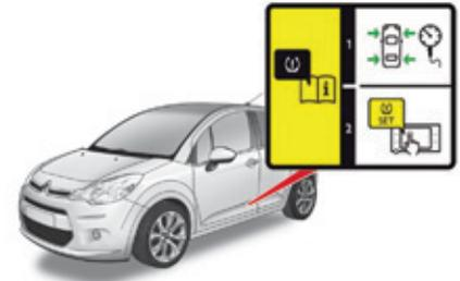
**!** Bevor Sie das System neu initialisieren, stellen Sie sicher, dass der Druck der vier Reifen den Nutzungsbedingungen des Fahrzeugs angepasst ist und den auf dem Reifendruck-Aufkleber stehenden Empfehlungen entspricht. Das System der Reifendruckerkennung gibt keine Meldung, wenn der Druck zum Zeitpunkt der Neuinitialisierung falsch ist.
