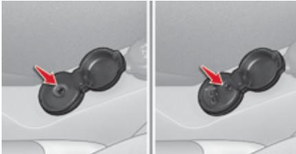
Dieser Anschluss befindet sich auf der Mittelkonsole im Bereich der "AUX"-Schnittstelle. An diesem Anschluss lässt sich ein tragbares Abspielgerät, wie z.B. ein iPod®, anschließen und Audiodateien können über die Lautsprecher des Fahrzeuges abgespielt werden.
