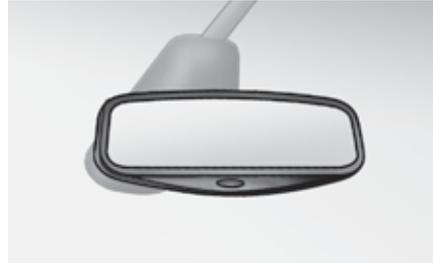
Mit Hilfe eines Sensors, der die Lichtverhältnisse hinter dem Fahrzeug misst, stellt sich der Rückspiegel selbsttätig und stufenlos von Tageslicht auf Dunkelheit um.
