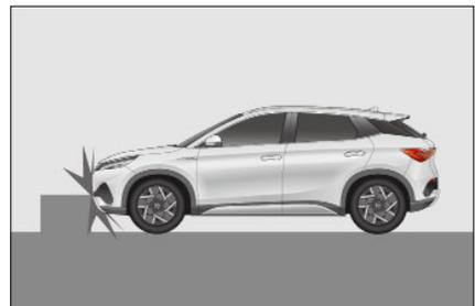
Die Fahrzeugnase setzt auf dem Boden auf, wenn ein starkes Gefälle befahren wird.
