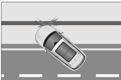
Seitenaufprall an anderen Teilen als dem Beifahrerraum.
