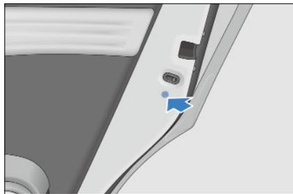
Der Aufkleber mit den Gebrauchshinweisen zum Ladesteckverbinder zum Ladesteckverbinder befindet sich auf der Innenseite der Ladeanschlussabdeckung.
